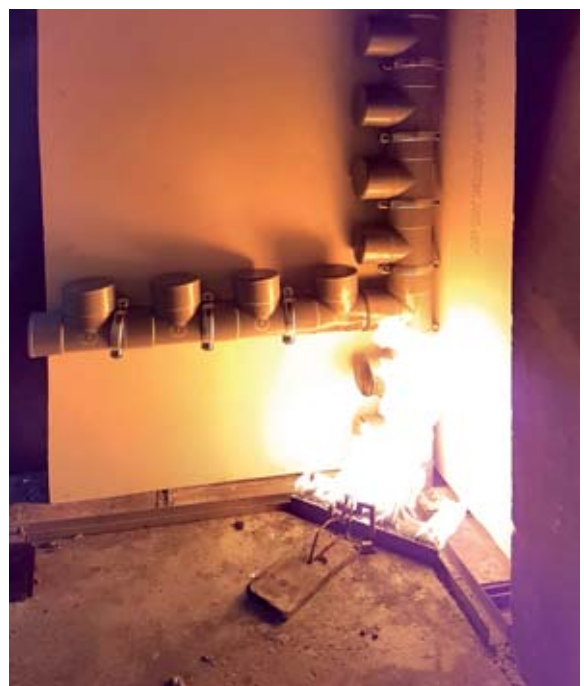
Ensayo SBI (Single Burning Item)
