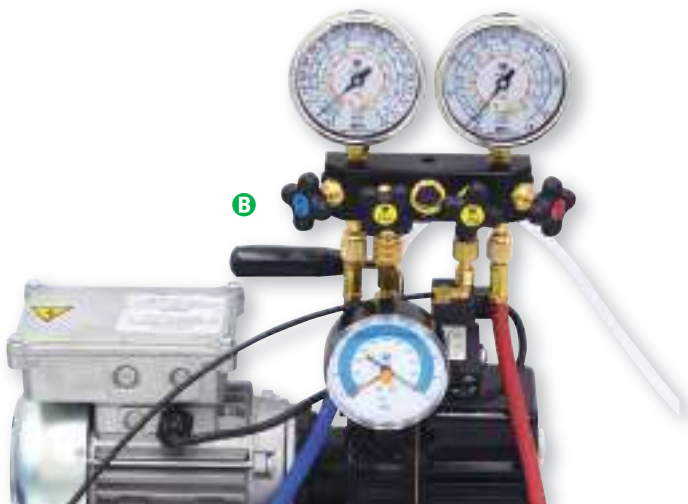
Detalle del kit equipado con electroválvula y vacuómetro
