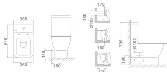
**Nota:** \*El conjunto inodoro completo está formado por: inodoro para tanque bajo BTW rimless, tanque completo 4/2 litros y asiento fijo. \*\*El conjunto inodoro completo está formado por: inodoro para tanque bajo BTW, tanque completo 4,5/3 litros y asiento fijo. BTW: Pegado a la pared. Todas las piezas se suministran en caja.
