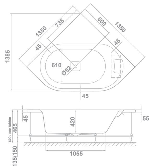
**Nota:** Acabados cromados. La bañera Flex Center sólo se suministra en color blanco. GALA recomienda la instalación de la bañera de hidromasaje con faldón, para facilitar el acceso a los componentes del hidromasaje en caso de necesidad. La bañera con hidromasaje lleva incorporados bastidor y desagüe automático.
