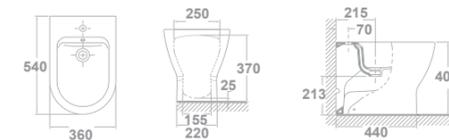
**Nota:** \*El conjunto inodoro completo está formado por: inodoro para tanque bajo BTW rimless, tanque completo de 4/2 litros y asiento fijo. BTW: Pegado a la pared. \*\* El conjunto inodoro completo está formado por inodoro para tanque bajo BTW, tanque completo de 4,5/3litros y asiento fijo. El tanque Emma se suministra en caja
