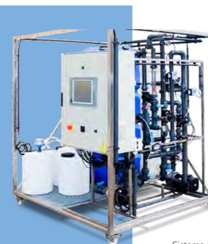
Sistema piloto de Ultrafiltración
